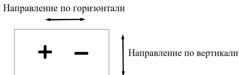
Рис. 1. Смещение УГО в горизонтальном и вертикальном направлениях.
