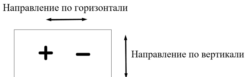
Рис. 1. Смещение УГО в горизонтальном и вертикальном направлениях.
